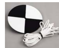
ภาพที่ 1 เซคติดิสก์ใช้วัดระยะทางที่แสงส่องผ่านน้ำ
